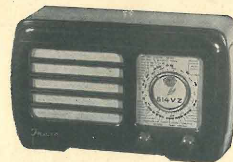
VZ. 514 - 5 valvole onde medie - Dim. cm. 10x15x25
